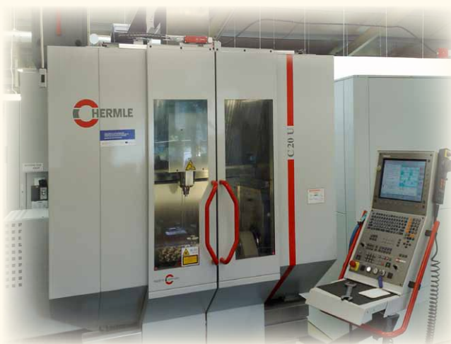
Specifické technické vybavení pořízené s využitím podpory z programu OPPI Potenciál - pětiosé frézovací centrum HERMLE a optické měřicí zařízení (3D scanner) ALICONA
